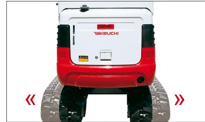
Raupenwerk mit hydraulischer Spurverbreiterung.
