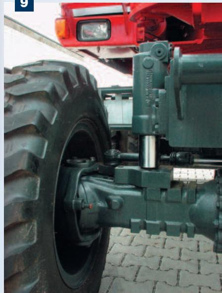
Lenkachse ist als Pendelachse ausgelegt die hydraulisch blockiert werden kann
